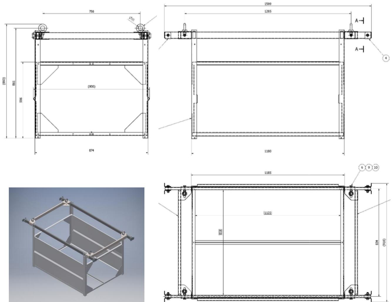
(die Zeichnung zeigt den Heberahmen an einem AQQA Rahmen montiert, der nicht Bestandteil des Lieferumfanges ist)
